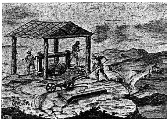
fig. 2 - verricello a braccia per l'estrazione del minerale di zolfo - da ILZOLFO - 1759
