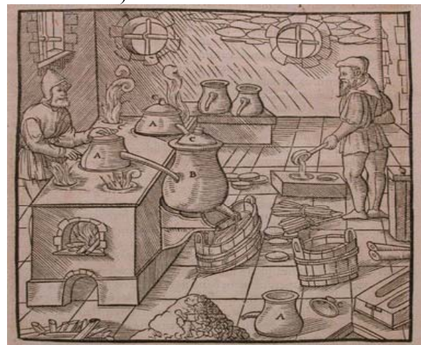
Hans Rodolf Manuel incisore a. 1561 in "De re metallica" di G. Agricola. Raffinazione dello zolfo.
