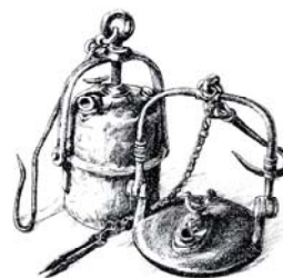
Lampade da minatore. Sulla sinistra lampada a carburo e sulla destra lampada ad olio.
