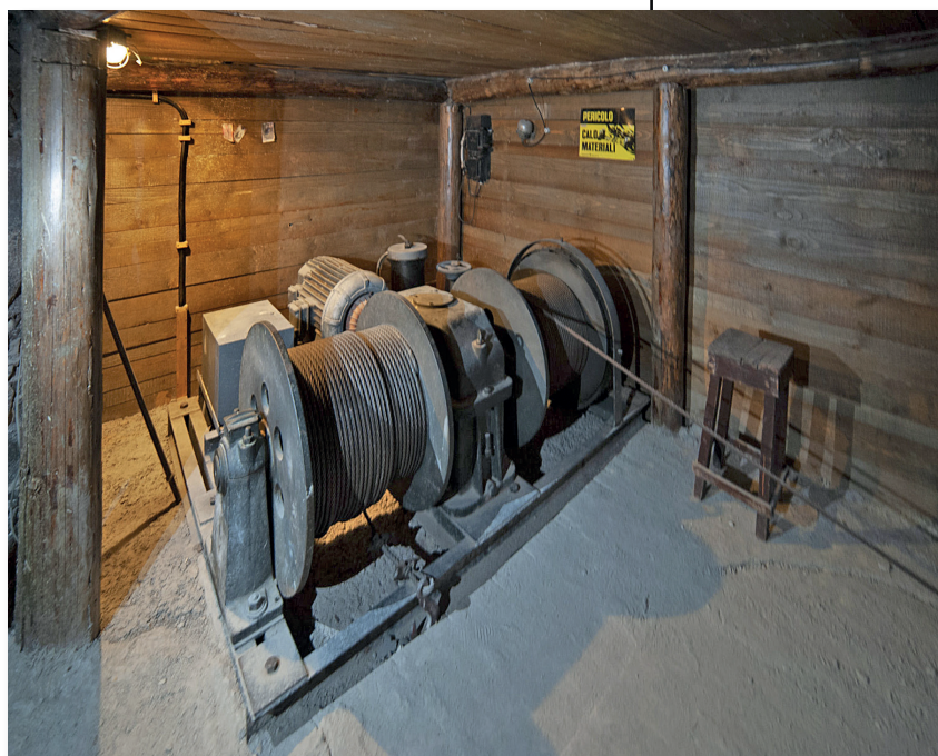
con l'arrivo dell'energia elettrica gli argani a motore soppiantarono quelli a trazione animale o manuali.
